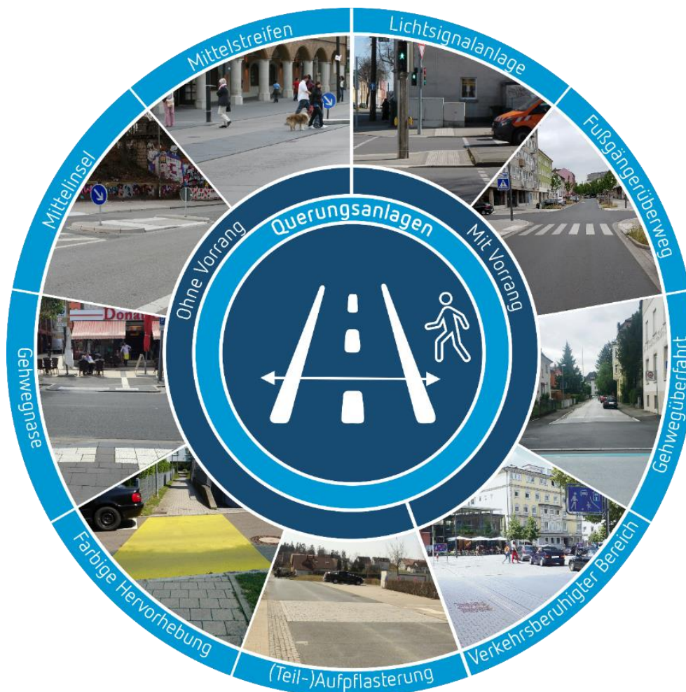
Abbildung 18: Unterschiedliche Querungsanlagen für zu Fuß Gehende
