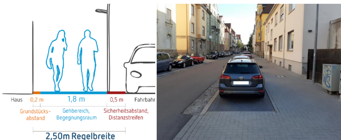
Abbildung 11: Regelbreite nach FGSV (links), Beispiele für eine Mindestgehwegbreite von 2,50 m (rechts)
