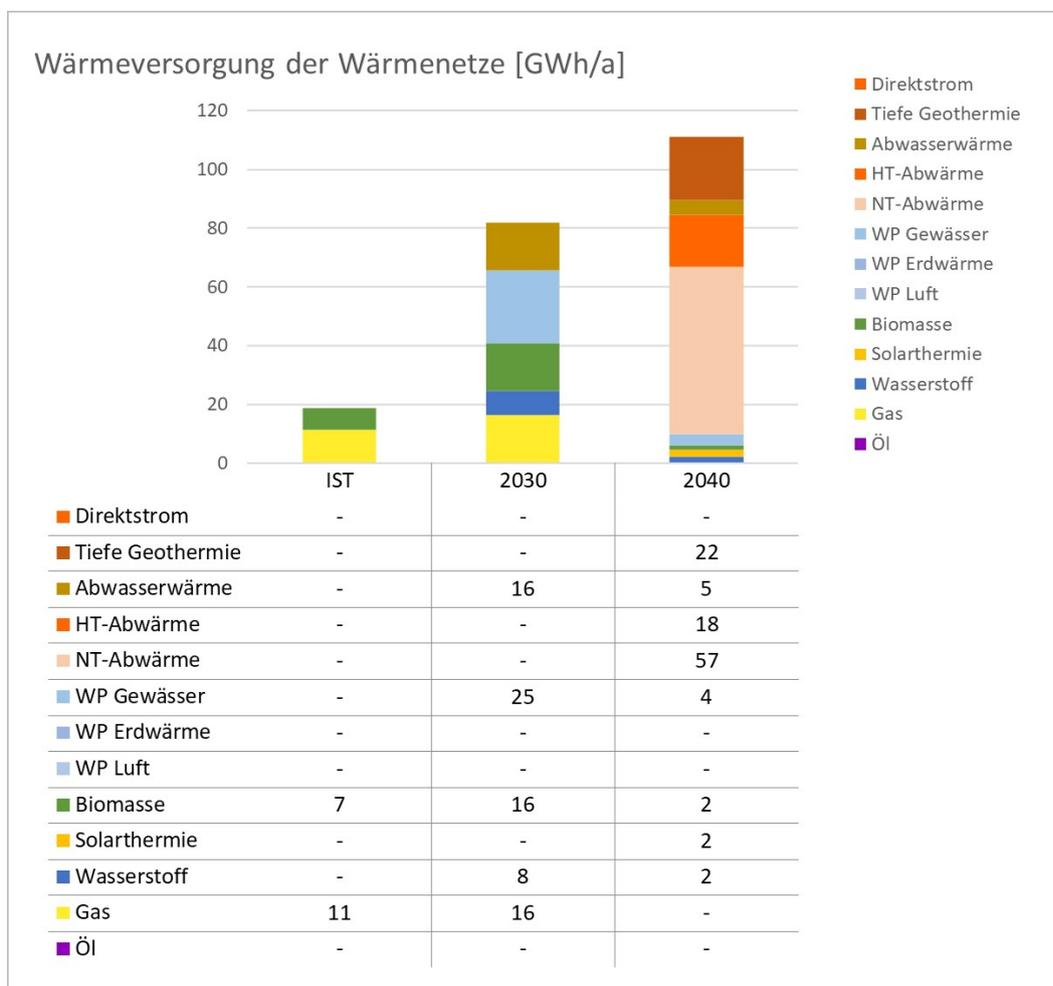
Abbildung 15: Eingesetzte Energieträger zur Wärmeversorgung der Wärmenetze in Weil am Rhein: IST, 2030, 2040.
