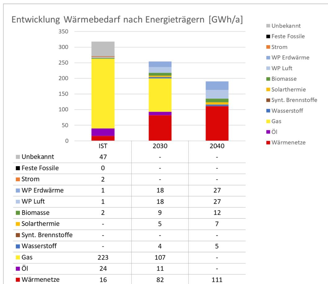
Abbildung 14: Entwicklung des Wärmebedarfs und eingesetzte Energieträger in Weil am Rhein: IST, 2030, 2040. Die angesetzten Reduktionsfaktoren sind im vorigen Kapitel erläutert.
