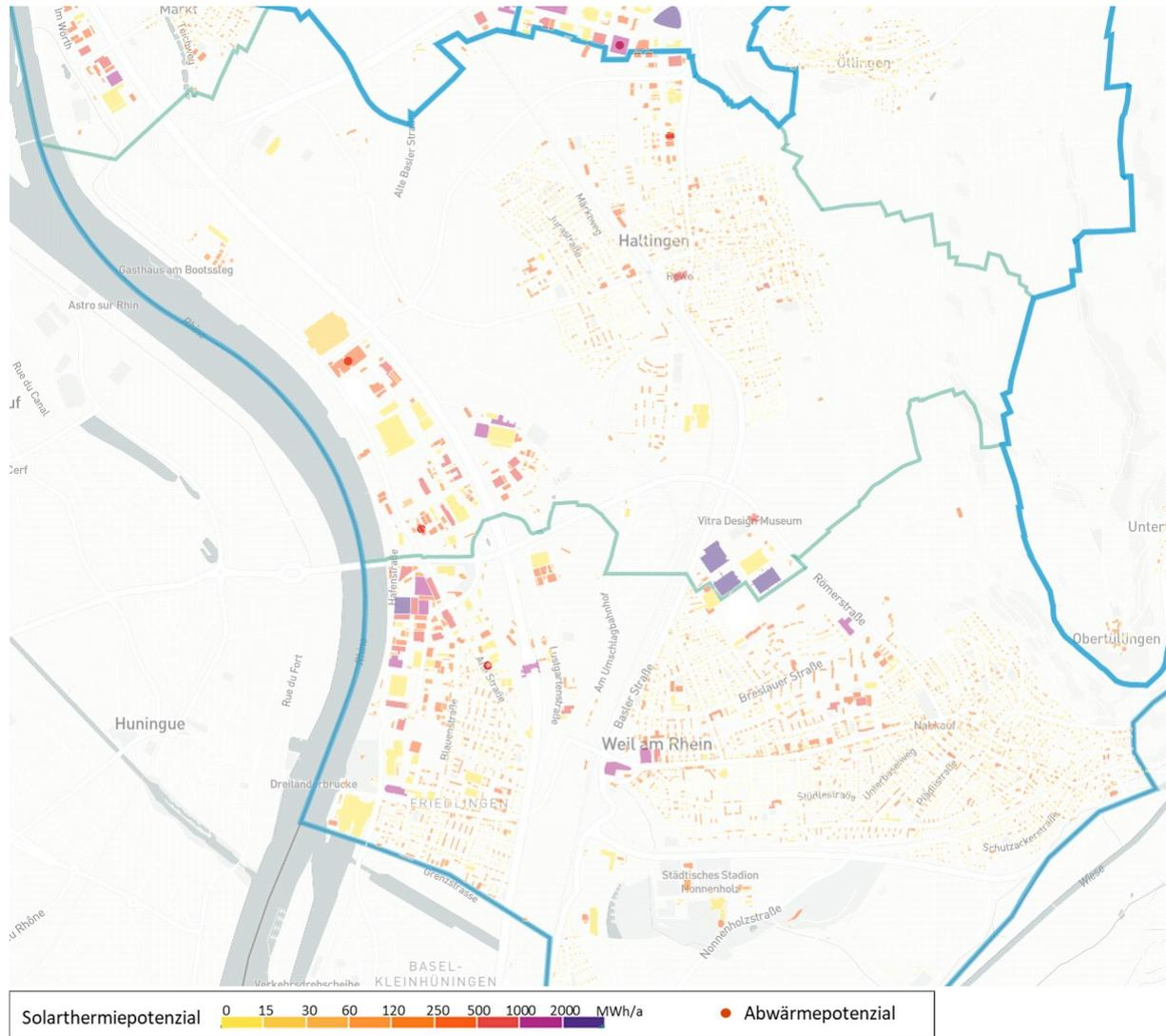
Abbildung 10: Innerörtliche Potenziale: Solarthermie und industrielle Abwärme in Weil am Rhein. (Die PV-Potenziale nutzen die identischen Flächen.) Zur besseren Erkennbarkeit ist ggf. nur ein Ausschnitt dargestellt.
